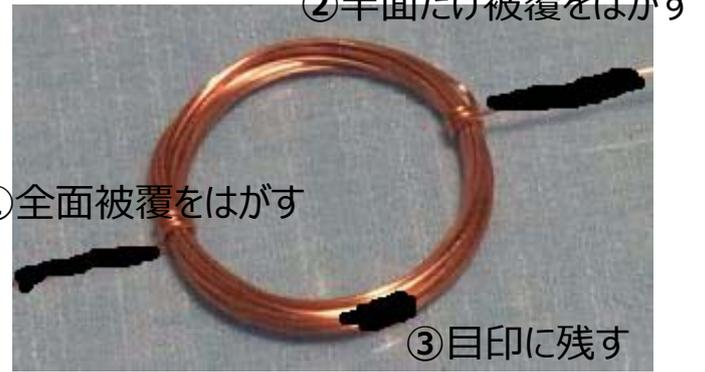
5. 片方の端部の被覆をはがします。サンドペーパーで挟んでこすります。被覆は固いので、じっくりと何度もやすりでこすります。マジックの黒色と被覆が取れると、銅がピカピカに見えます。できれば銅線の被覆が取れているか、テスターで確認しましょう。
